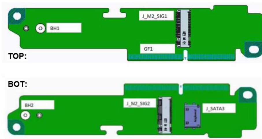
図 8. M.2 X 16 SATA ライザー PCB の寸法
